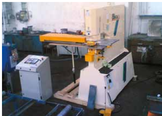
Stroj Puma 55 vybavený číslíkové řízeným, polohovacím stolem
