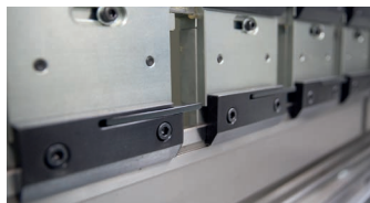
▶ kézi felső szerszám gyors befogás
