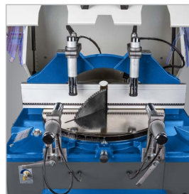
▶ alapfelszereltségként négy pneumatikus szorítóhengerringel
