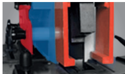
▶ kivágó állomás (HPS 45S-től)
