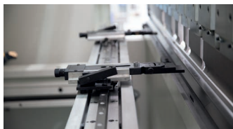
▶ X/R hátsó ütköző manuális Z-tengellyel
