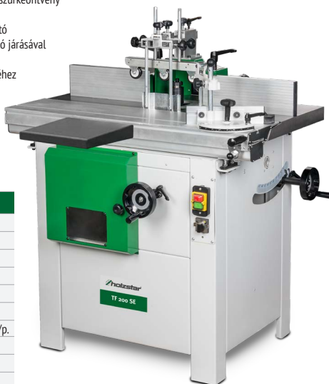
▶ a maróorsó hátrafelé fordítható az adagolóeszköz optimális használatához, a maximális biztonsághoz és a tiszta marási mintázathoz
