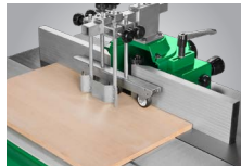
▶ vezetőlécc finoman állítható alumínium ütközőkkel
