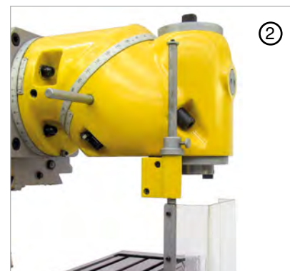
DIGI modell könnyen kezelhető LED kijelzővel a pontos helyzet leolvasásért. Kizárólag DIGI-gépeinknél.
