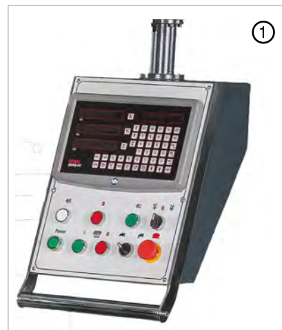
DIGI modell könnyen kezelhető LED kijelzővel a pontos helyzet leolvasásért. Kizárólag DIGI-gépeinknél.
