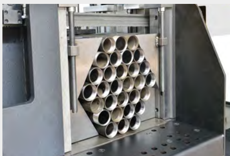
hatszögletű befogó csövek kötegeléséhez
