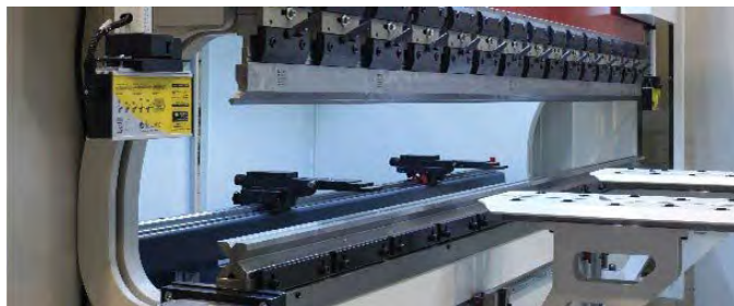
KÉP: A PRÉSGÉP MUNKATERÜLETE (GBP 2.550-120) KIEGÉSZÍTŐ BERENDEZÉSEKKEL, GYORSCSERÉLŐ SZERSZÁMTARTÓKKAL ÉS FÉMLEMEZ EMELŐVEL
