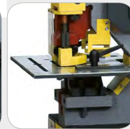
Kalapács Max. kapacitás 28 x 15 mm és 38 x 11mm
