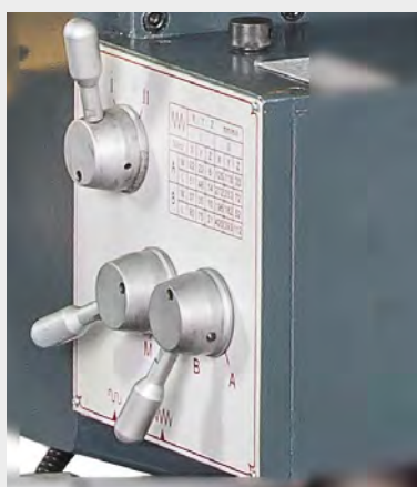
X-, Y- és Z-tengely 8 asztalsebesség állítható
