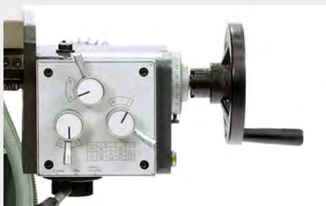
automatikus előtolás az X-tengely mentén (8 sebességfokozat)
