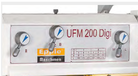
12 orsósebesség állítható a vezérlőpanelen
