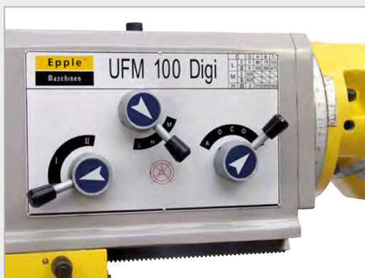
11 orsósebesség állítható a vezérlőpanelen
