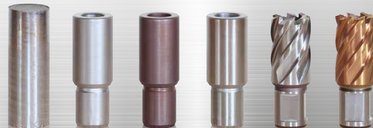
Unbearbeitete Stangenware Mechanisch bearbeitet Gehärtet Auf Außenmaß geschliffen Mit Spannutt und Endzahn geschliffen VarioPLUS Kernbohrer beschichtet
