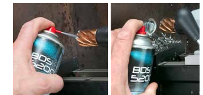
Schritt 1: Vor dem Bohrvorgang Hochleistungs-Fettspray direkt in den Bohrer sprühen.
