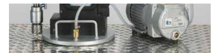
Vakuumplatte für glatte Riffel- / Kreuzbleche
